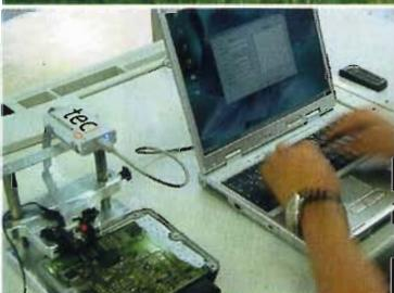
Tuning über die Schnittstelle. Per Laptop wird der veränderte Datensatz...
